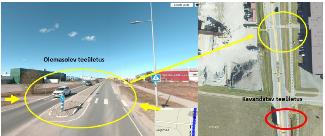
Joonis 5 . Olemasoleva (varem välja ehitatud) ülekäiguraja ja kergliiklusteede lahendus (kollane) ja tee ehitusprojektiga planeeritava ülekäiguraja asukoht (punane).
